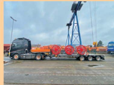
Die ausgebaute Treibradsatzgruppe auf dem Weg zur weiteren Bearbeitung bei der MaLoWa in Klostermansfeld
