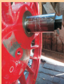
Treibzapfen außerhalb der Werkstoleranz
